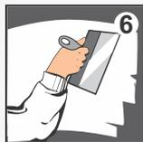
**6** Шпатлевку БОЛАРС Финишная LR нанесите стальным шпателем на основание слоем от 0,3 до 3 мм. Для получения более толстого слоя допускается шпатлевание в несколько слоев. Последующий слой нанесите после полного высыхания предыдущего, предварительно прогрунтовав. При грунтовании тщательно выжимайте валик о лоток для предотвращения размокания шпатлевки.
