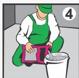
**4** Для подготовки раствора залейте водопроводную воду комнатной температуры в чистую ёмкость из расчёта 0,28 - 0,32 л воды на 1 кг сухой смеси.
